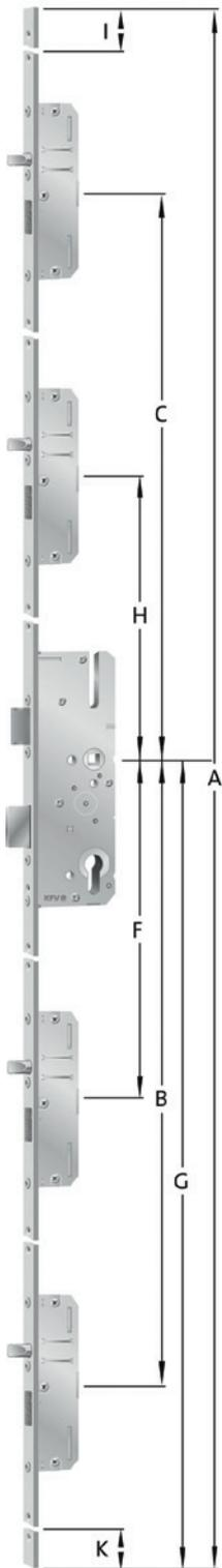
Schwenkriegel mit oder ohne Rundbolzen
